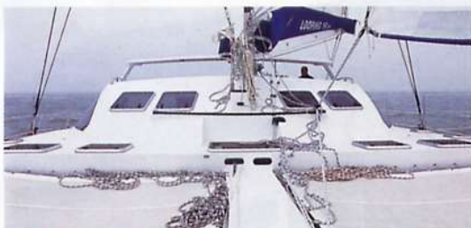
LES DEUX OÜÏES au-dessus de la poutre transversale captent l'air frais, distribué ensuite dans les cabines.
